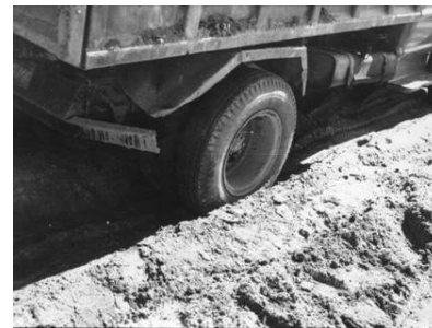
软土地基上无加筋无铺装路面的典型受力压缩机制
